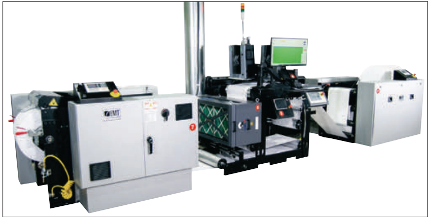
Das MCS TK17 Drucksystem mit 2 x 8540 Flex-Hybrid- und 2 x 4.25 Flex-Druckköpfen für Spot Color. (Generalimporteur EU: profi-tec GmbH, Rheine) Als Ab- und Aufwicklermodul können die Systeme aller gängigen Hersteller verwendet werden.
